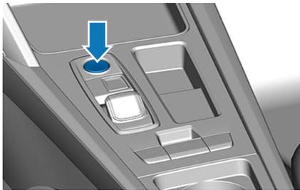
Presionar el pulsador START - ENGINE - STOP, situado en la consola central, sin accionar el pedal del freno.
