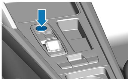
Appuyez sur le bouton START - ENGINE - STOP situé sur la console centrale sans actionner la pédale de frein.
