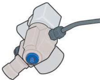
manueller Absperrhahn am Fuß des Flaschenventils.
