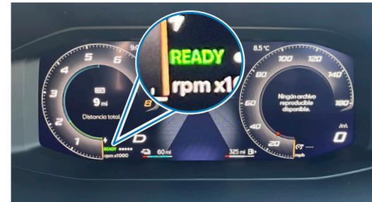
Cuadro de instrumentos digital con indicador de potencia (powermeter) e indicador "OFF" o "READY", mostrado aquí como ejemplo en la familia eHybrid.
