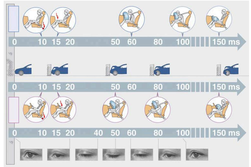
El disparo de los sistemas de seguridad se produce en función del tipo de accidente o el sentido de la colisión (ms = milisegundos).
