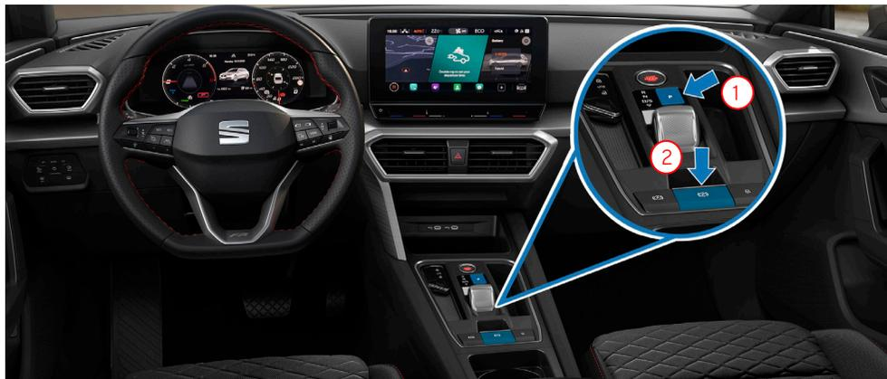
**Vehículo con cambio automático sin palanca selectora: pulsar la tecla “P” (1) y accionar el freno de mano eléctrico (2).**
