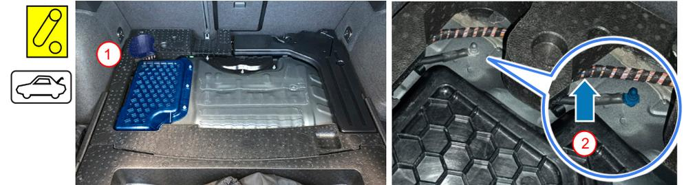
Ejemplo de desconexión del sistema de 12 V en un León PHEV.
