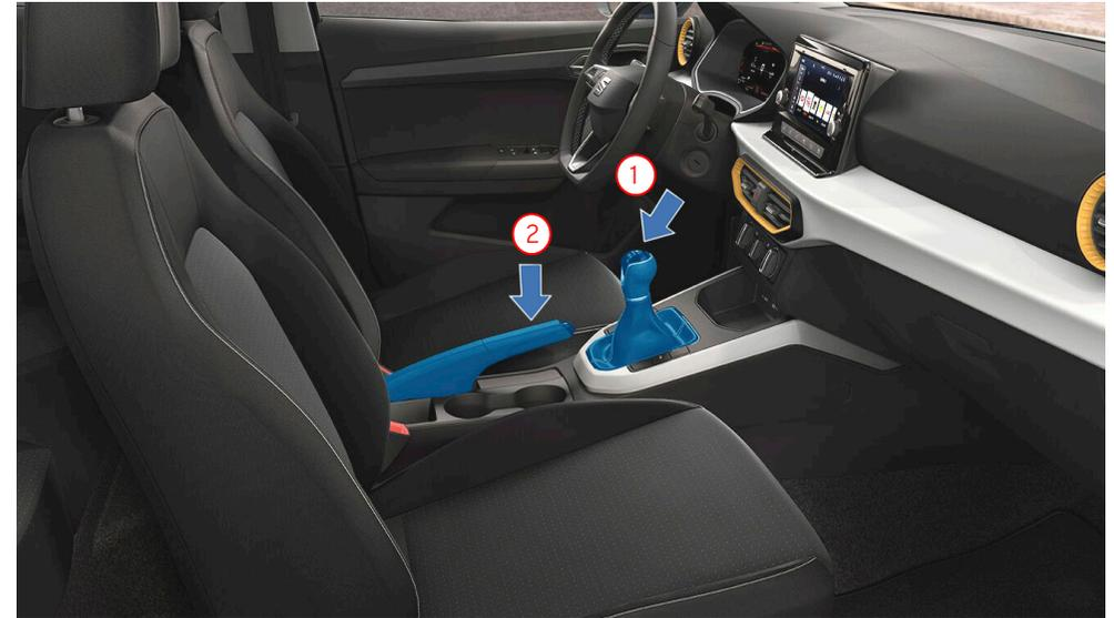
**Vehículo con transmisión manual: Coloca la palanca de cambios en punto muerto (1) y acciona el freno de mano (2).**
