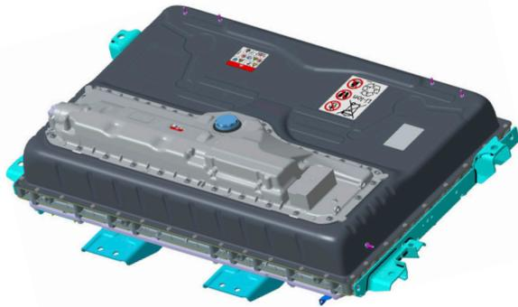
Ejemplo de una batería de alto voltaje del LEON eHybrid
