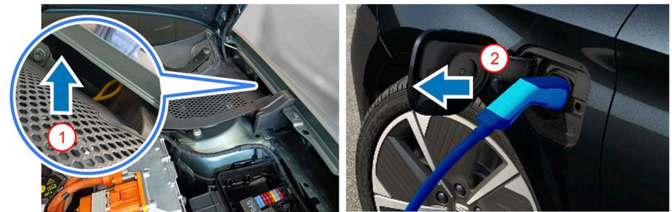
Beispielhafte Anordnung der Notentriegelung von der Ladestation (LEON PHEV):
