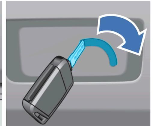
Schlüssel in den Schlitz einführen und zum Entriegeln durchziehen
