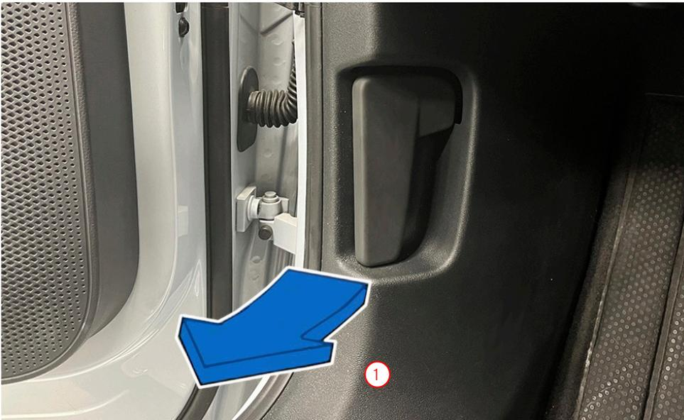
Im Fußraum auf der Fahrerseite: Entriegelungshebel für die Motorhaube
