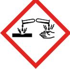
**Hautkontakt und Einatmen von Elektrolytdämpfen vermeiden, da Elektrolyte entzündbar, korrosiv und reizend sind.**
