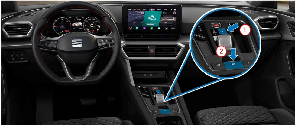
**Fahrzeug mit Automatikgetriebe ohne Gangwahlhebel: Taste „P“ [1] drücken und elektrische Feststellbremse [2] betätigen.**
