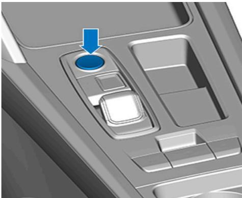
Fahrzeug mit „START-ENGINE-STOP“-Taste in der Mittelkonsole
