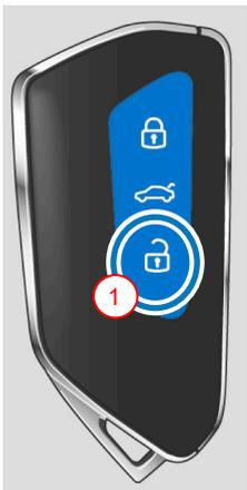
Taste an der Fernbedienung des Fahrzeugschlüssels
