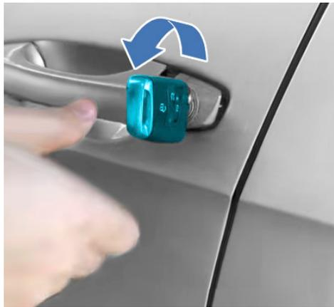
Durch Drehen des Schlüssels entriegeln
