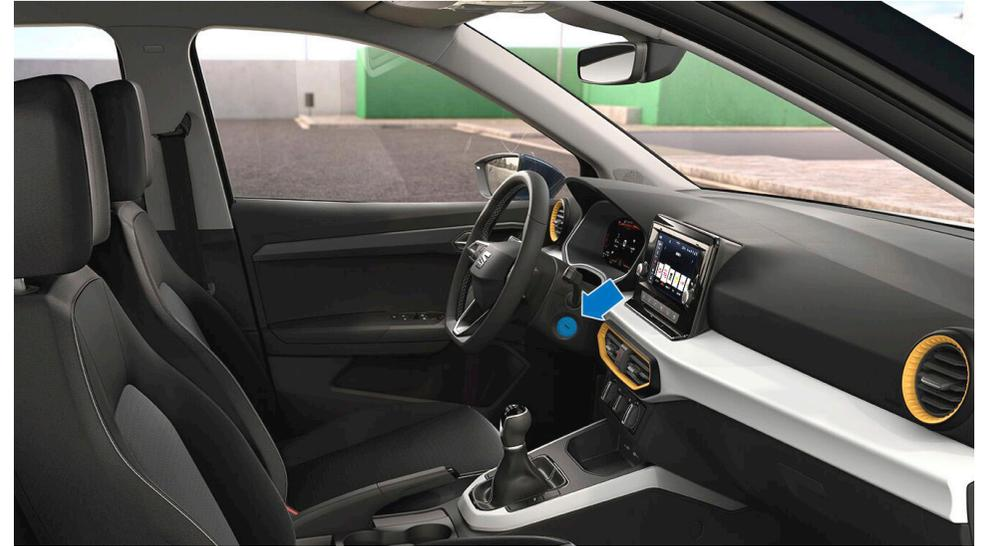
Fahrzeug mit „START-ENGINE-STOP“-Taste an der Lenksäule.
