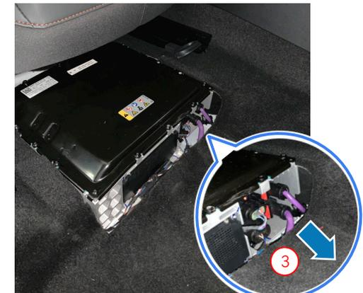
Trennung des 48-Volt-Bordnetzes bei Mild-Hybrid-Fahrzeugen (MHEV)
