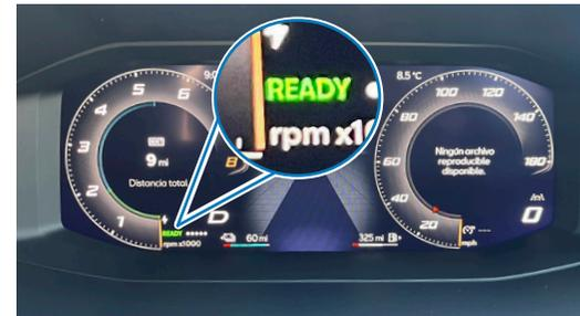
Digitales Kombi-Instrument mit Leistungsanzeige (Powermeter) und Anzeige „OFF“ bzw. „READY“, hier beispielhaft für die eHybrid-Familie dargestellt
